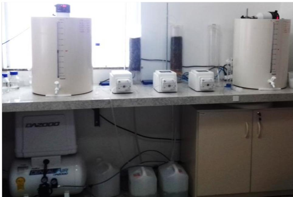
Figura 1: Protótipos em escala de bancada para biolixiviação em colunas e em tanques agitados.
