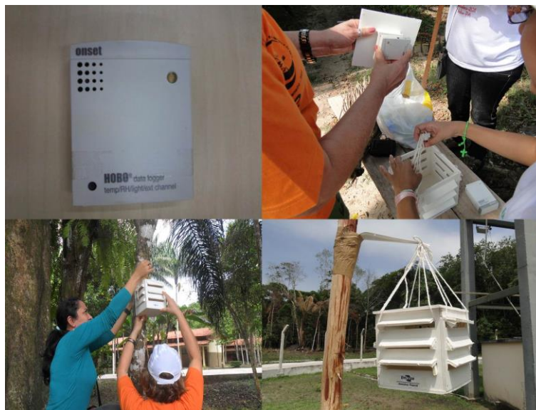
Figura 3. Instalação dos mini-abrigos agrometeorológicos para monitoramento térmico – hídrico no Bairro Mutirão, Abaetetuba, Pará (14/12/2013 a 06/01/2014).
