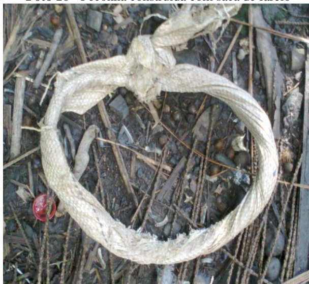
Foto 16 - Peconha construída com saca de farelo
