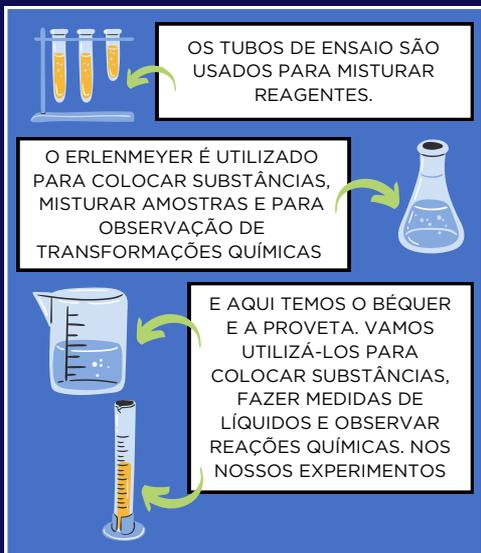
OS TUBOS DE ENSAIO SÃO USADOS PARA MISTURAR REAGENTES.
