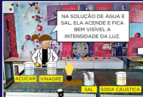
NA SOLUÇÃO DE ÁGUA E SAL, ELA ACENDE E FICA BEM VISÍVEL A INTENSIDADE DA LUZ.
