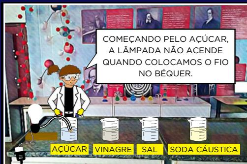
COMEÇANDO PELO AÇÚCAR, A LÂMPADA NÃO ACENDE QUANDO COLOCAMOS O FIO NO BÉQUER.
